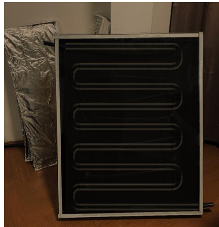
Colector solar plano de materiales reciclados
